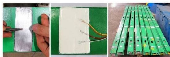
图 15 测力箱梁制作过程
